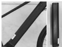
Fig. 18 e 18.1 Bateria localizada dentro do quadro
